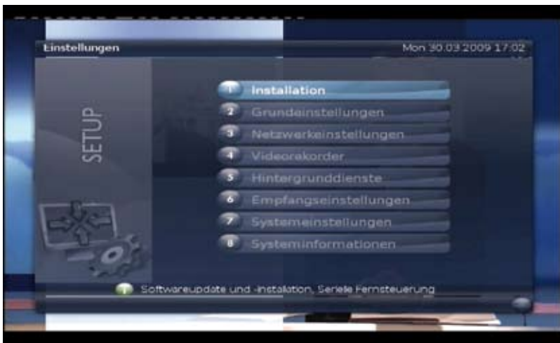
Mit dem Druck auf die „Setup-Taste“ gelangten wir in das Einstellungsmenü des Testkandidaten. Auch dort herrscht eine klare und dennoch ansprechende Struktur sowie die Onlinehilfe der herkömmlichen Menüs. Die Menüpunkte lassen sich nicht nur mittels des Navigationskreuzes, sondern zudem über die Nummerntasten ansprechen.
